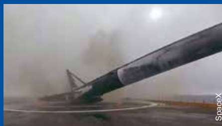
▲ Последовательные снимки посадки первой ступени ракеты Falcon 9 на плавучую платформу в Тихом океане 17 января 2016 г. Блокировка фиксатора одной из четырех посадочных опор (вероятнее всего, связанная с толстым слоем льда, намерзшим из-за сильного тумана во время предстартовой подготовки на авиабазе Ванденберг) вызвала ее нештатное складывание с дальнейшим падением и взрывом ступени.
