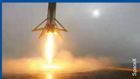
▲ Последовательные снимки посадки первой ступени ракеты Falcon 9 на плавучую платформу в Тихом океане 17 января 2016 г. Блокировка фиксатора одной из четырех посадочных опор (вероятнее всего, связанная с толстым слоем льда, намерзшим из-за сильного тумана во время предстартовой подготовки на авиабазе Ванденберг) вызвала ее нештатное складывание с дальнейшим падением и взрывом ступени.
